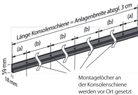
Montagelöcher an der Konsolenschiene werden vor Ort gesetzt
